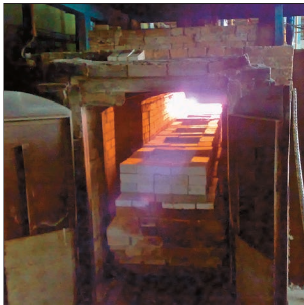
Уникальная термическая печь для прокаливания носителей катализаторов при температурах до 1500°C. Керамические носители нужны для получения термостабильных, механически прочных катализаторов, работающих при высоких температурах (в процессах конверсии углеводородных газов, получения защитных атмосфер и др.).
