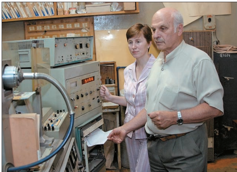
Исследование катализаторов, сырьевых компонентов, носителей с применением рентгеновского дифрактометра. Рентгеновский метод — один из самых информативных для наших целей: с его помощью определяется фазовый состав и степень дисперсности компонентов катализаторов.
